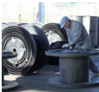
電線ドラムの組み立て・リユース
